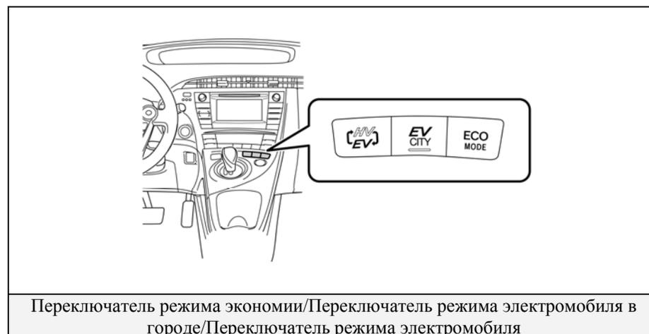
Переключатель режима экономии/Переключатель режима электромобиля в городе/Переключатель режима электромобиля
